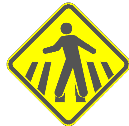
A32b - PASSAGEM SINALIZADA DE PEDESTRES DETALHE DE PLACA DE SINALIZAÇÃO esc 1:25
