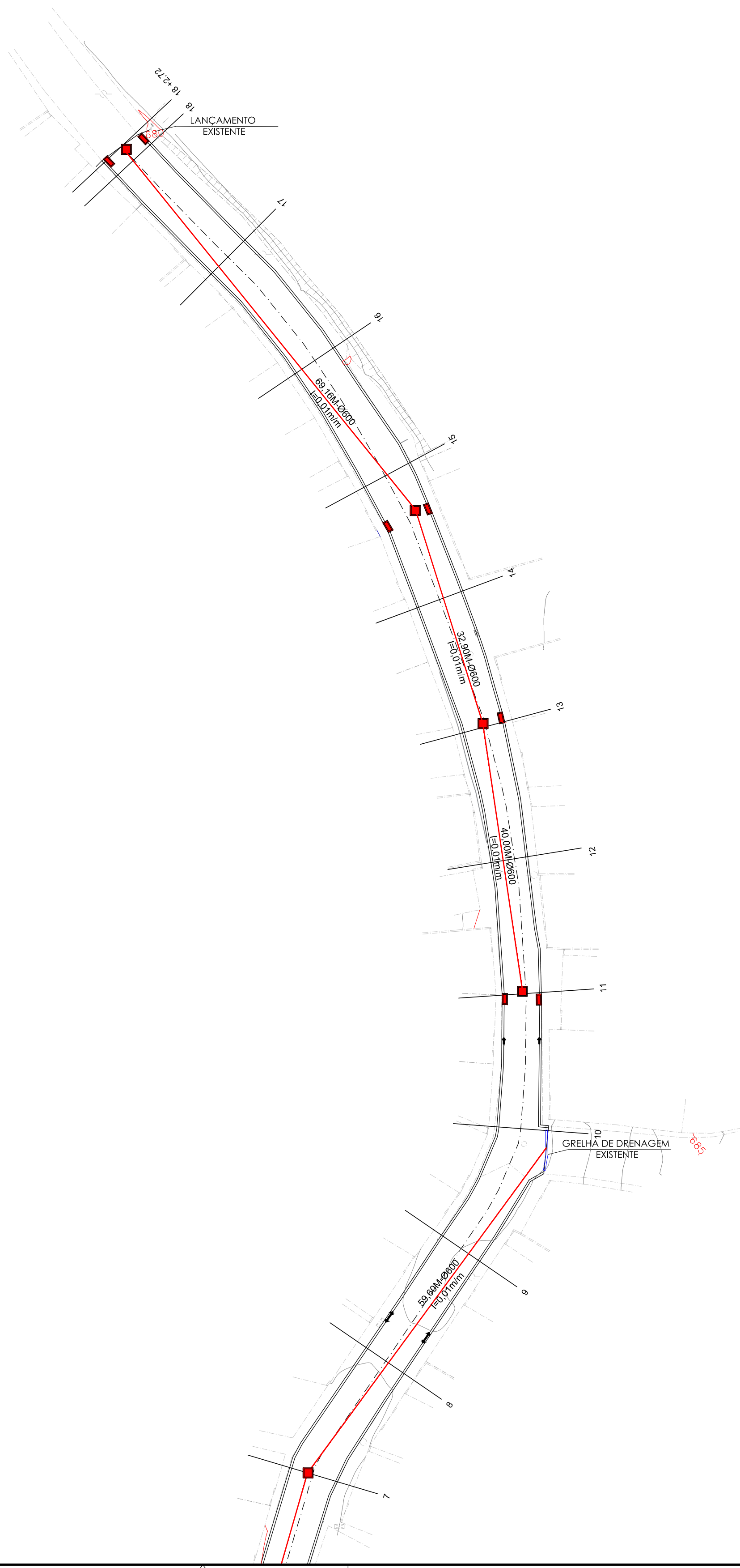
PLANTA BAIXA DE DRENAGEM EST 7 A EST 18+2,72 esc 1:500
